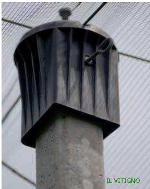
Los capuchos cobre-postes se introducen haciendo una presión en la extremidad superior el poste, al que adhieren perfectamente sin deshilarse porque la sección del agujero es un poco más pequeña de la del poste. Como ulterior precaución se ha colocado un tornillo con ojal para poder fijar el capucho de manera definitiva.
